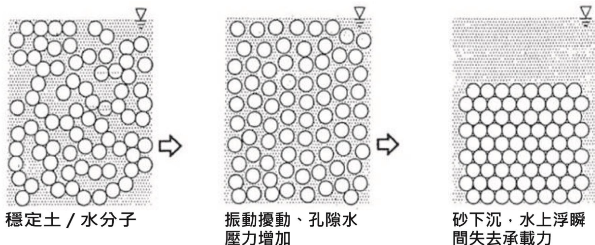
圖16-1 土壤液化過程（出處：池體演建築師提供）
