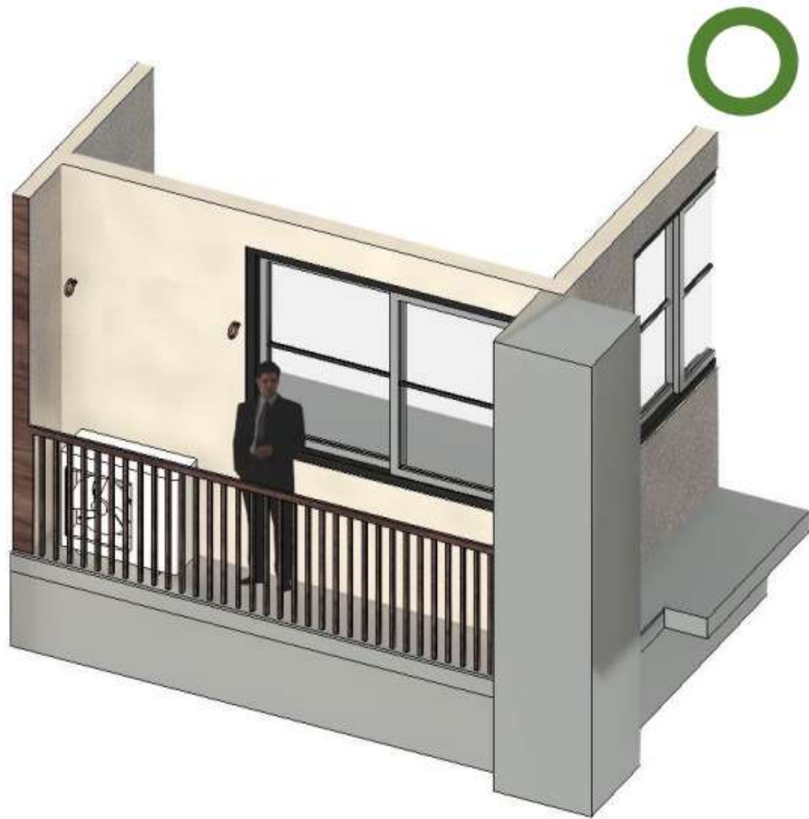
圖 2-2、露樑設置室外機範例
